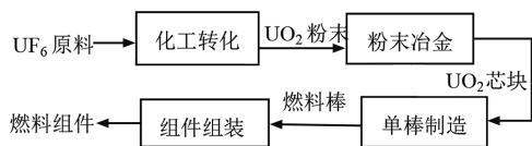
图 1 AP1000 核燃料元件总工艺流程
